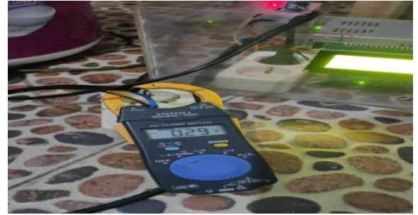
Gambar 8 Pengujian Tegangan Menggunakan Ampere meter
