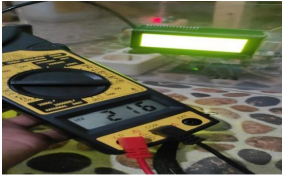
Gambar 7 Pengujian Tegangan Menggunakan Volt Meter
