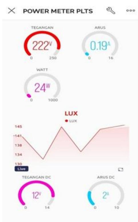
Gambar 2: Pengukuran Melalui Tampilan Android
