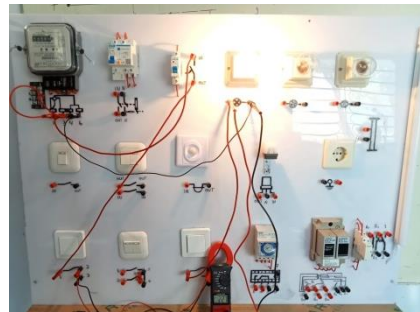
Gambar 13 . Pengukuran tegangan pemakaian CB, saklar tukar dan kotak kontak dengan satu lampu pijar.
