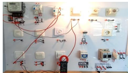
Gambar 14 . Pengukuran arus pemakaian CB, saklar tukar dan kotak kontak dengan satu lampu pijar.
