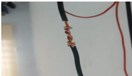
Gambar 2. Sambungan Puntir / sambungan yang mengalami tarikan.
