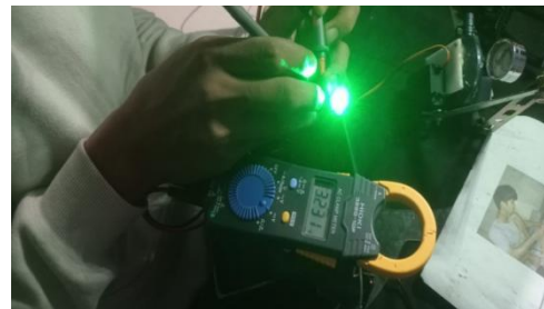
Gambar 4.4 Tegangan LED 3,23 volt
