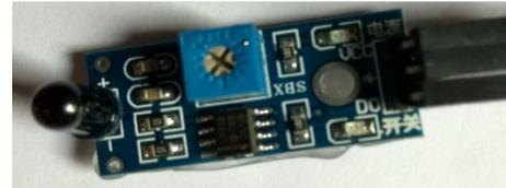
Gambar 3. Sensor Infra Merah
