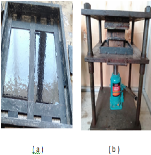
Gambar 3. (a) Cetak material dan (b). Press material
